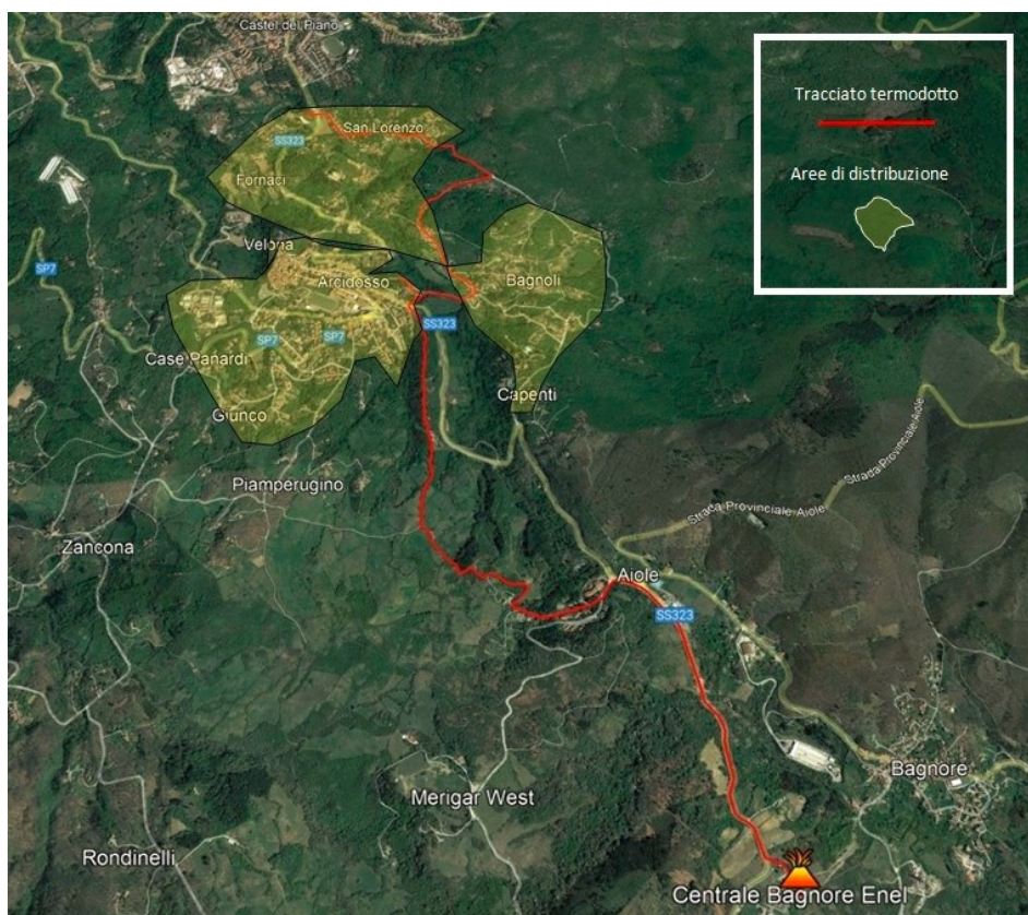
Figura 2: Termodotto e reti di distribuzione in costruzione (estratto da Estensione della rete di teleriscaldamento di Arcidosso. Documento di indirizzo alla progettazione, Immagine 1)
